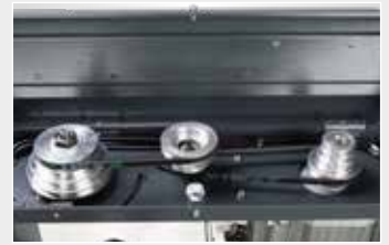
Fig. Belt drive DQ 22. Two belt pulleys for DQ 14/18
